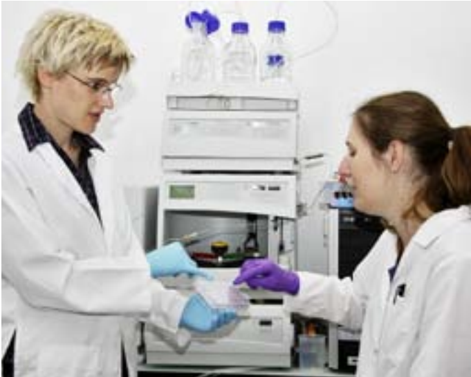
Nadine Bramaz et Hana Mestankova discutant des résultats sur la toxicité des mélanges de produits de transformation et de substance mère obtenus sur plaques de microtitration. En arrière-plan, le chromatographe utilisé pour déterminer la concentration de substance d'origine dans le mélange au cours de la transformation.
