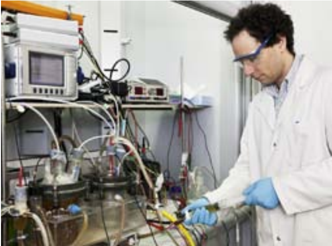
Im Labor forscht Verfahrenstechniker Kai Udert an verschiedenen Reaktoren, um Nährstoffe und Verunreinigungen aus dem Urin abzutrennen.
