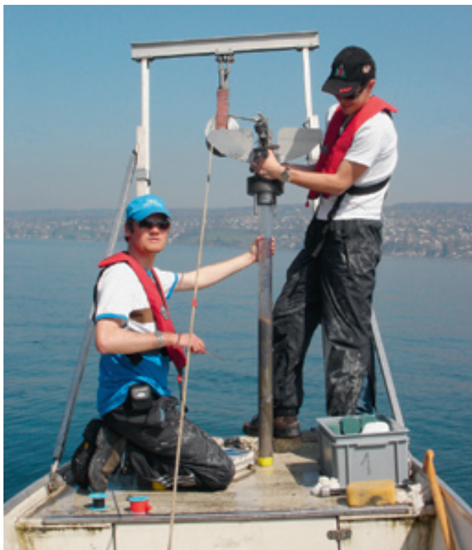
Prélèvement d'une carotte sédimentaire à partir du bateau.
