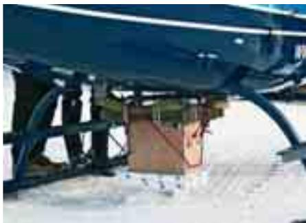
Die Infrarokamera wurde am Helikopterboden montiert.
