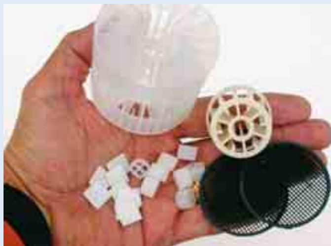
Billes de polystyrène expansé et éléments de plastique comme supports de biofilms pour les lits fixes et les lits fluidisés.
