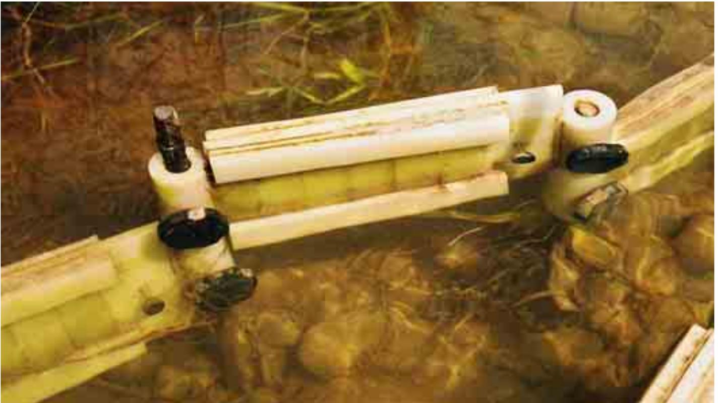
Le dispositif expérimental installé dans le Furtbach: Les biofilms d'algues se développent sur des plaques de verre.
