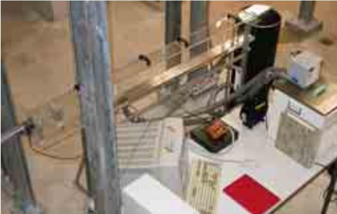
Abb. 2: Der Laborprüfstand, an dem der Einfluss der Biofilmbildung auf die Leistung des Wärmetauschers getestet wurde.
