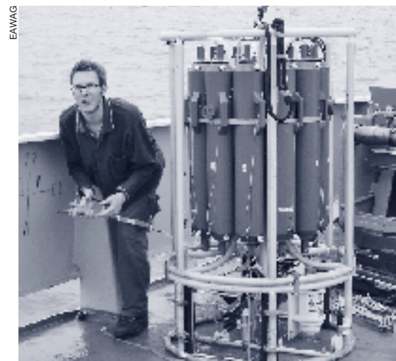
Zum Heraufholen der Wasserproben dient ein Gerät mit 12 Wasserflaschen, die vom Schiff aus in verschiedenen Tiefen geschlossen werden können.
