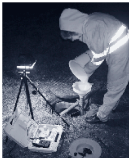
Exfiltrationsexperiment: Zugabe der NaCl-Lösung als Referenzsignal.
