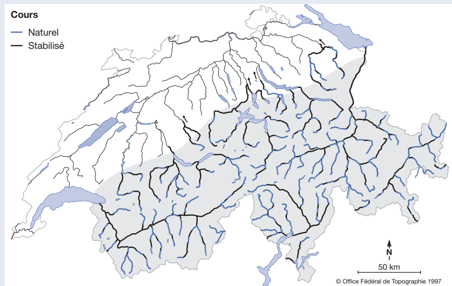
Fig. 2: Cours d'eau alpins au cours corrigé. Adapté de [14].
