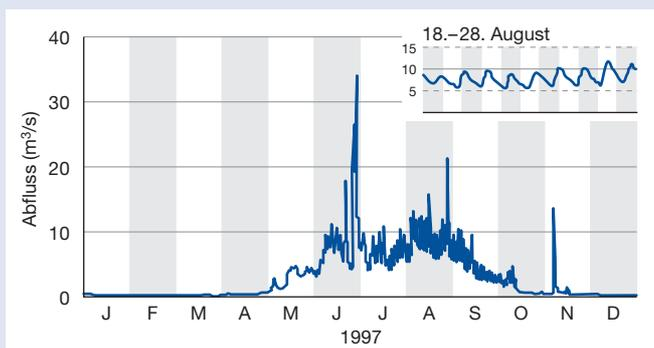
Abb. 3: Hydrograph des Roseg. Die täglichen Abflussschwankungen im August sind die Folge einer verstärkten Gefrier-Auftau-Dynamik während der Warmwetterphasen.
